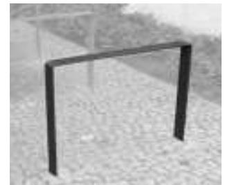
*Kreuzberger Bügel III*, Fa. Abex; Flachstahl 60/12 mm, Breite 800 mm, mit abgerundeten Ecken, dunkelgrau in Ensembleschutzgebieten und bei hoher Einzeldenkmaldichte
