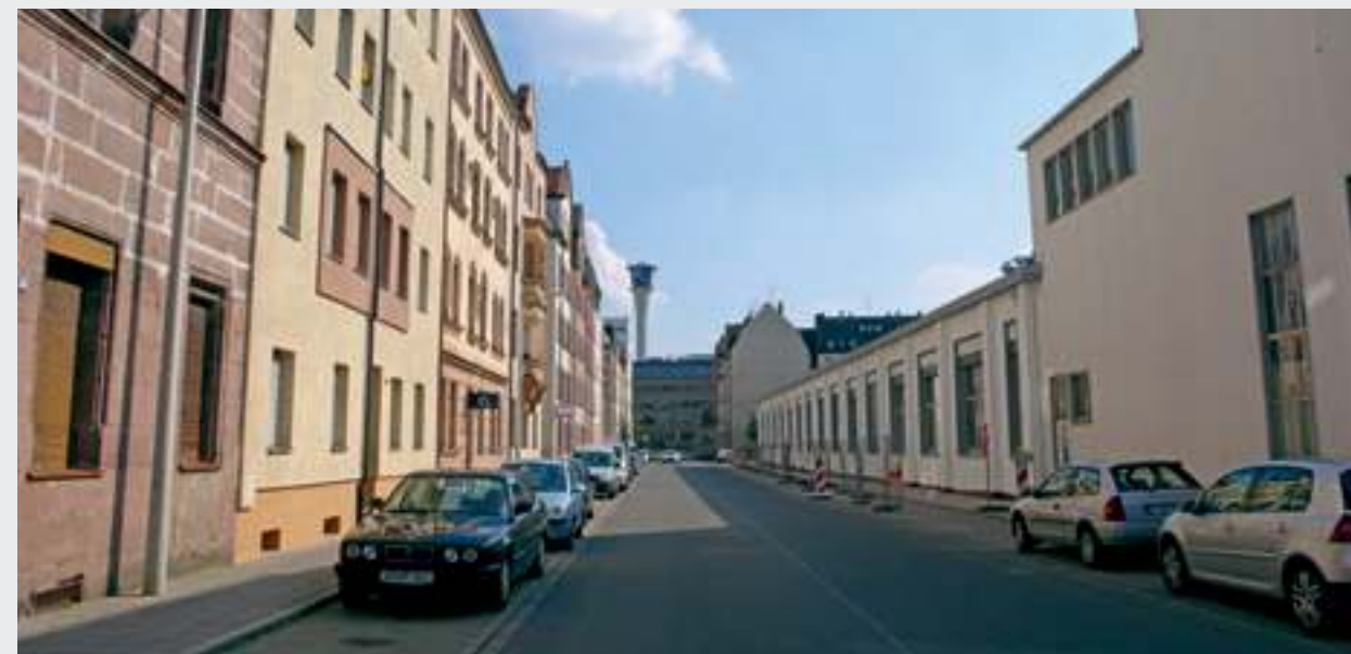
Abb. 3.4: In der Weststadt ist der Effekt der gegenseitigen Gebäudeverschattung aufgrund der breiten Straßenquerschnitte begrenzt.
